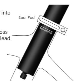
**⚠️** Ein unzureichendes Einführen der Sattelstütze in das Sitzrohr des Fahrradrahmens kann zu einer Beschädigung der Sattelstütze und/oder des Fahrrads führen und den Verlust der Kontrolle über das Fahrrad zur Folge haben, was zu schweren Verletzungen oder zum Tod führen kann.
